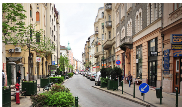
SZYKANY - ELEMENTY WYMUSZAJĄCE ZMIANĘ KIERUNKU RUCHU - SKUTECZNIE SPOWALNIAJĄ PRĘDKOŚĆ SAMOCHODÓW.
